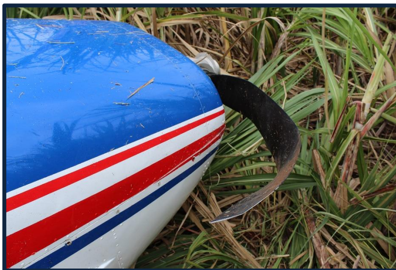
Fotografía No. 11 Vista de la parte trasera de los daños en la hélice.
