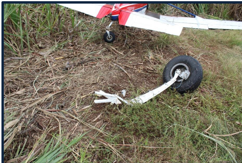
Fotografía No. 07 Vista del tren de aterrizaje derecho separado por fractura.
