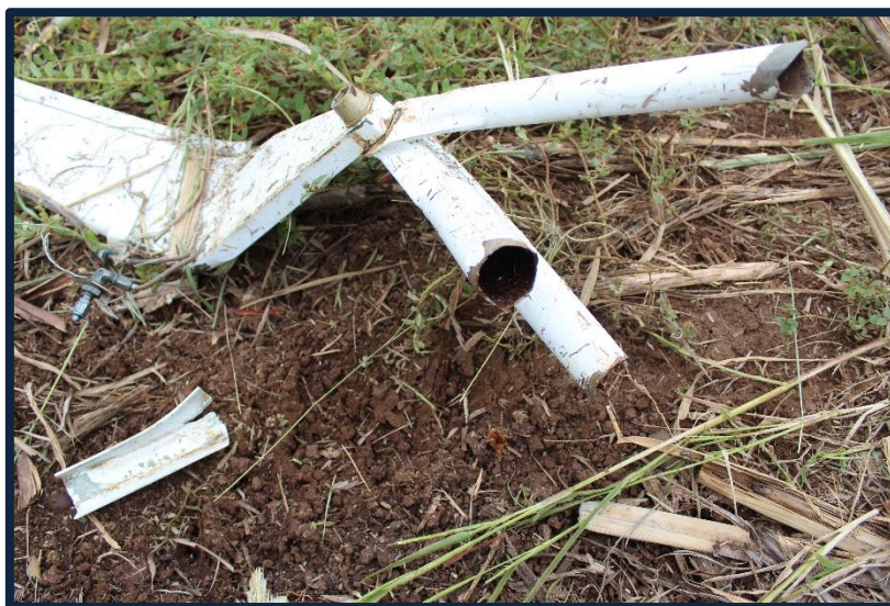
Fotografía No. 09 Vista de los soportes del tren de aterrizaje fracturado.
