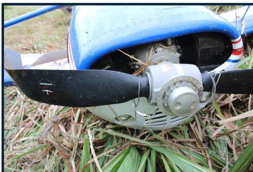
Fotografía No. 10 Vista de daños en la hélice.
