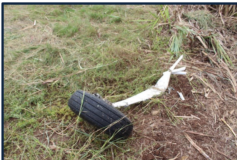
Fotografía No. 08 Vista del tren de aterrizaje izquierdo quebrado.
