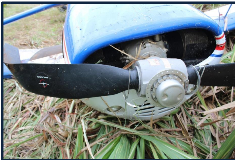
Fotografía No. 05 Vista de frente de la hélice con daños en las aspas.
